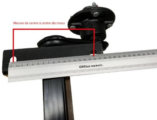
***Exemple de platine d'un essieu standard***
