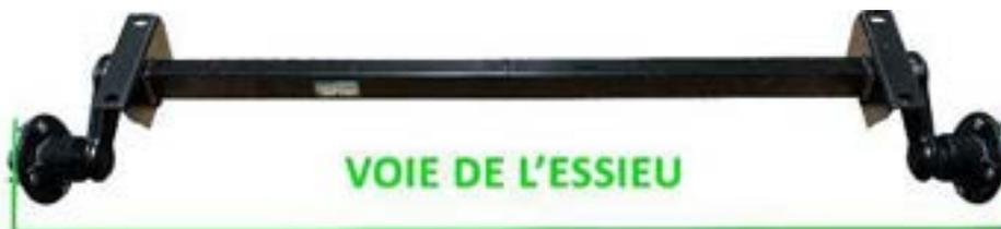
Grâce aux caractéristiques (voie et EAB), vous pourrez déterminer le « **déport** » de l'essieu (voir ci-dessous). Pour calculer le **déport de l'essieu**, vous devez réaliser le calcul suivant :  $(\text{Voie} - \text{EAB}) / 2$
