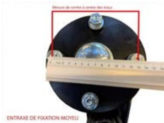
L'entraxe de fixation du moyeu correspond à la distance entre 2 trous de fixation d'axe à axe en diagonale (Cf. photo ci-dessus).
