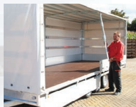
▲ Bâche accessible sur les quatre faces, pilier central amovible
