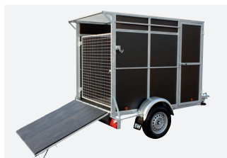
Rampe de chargement + porte intérieur en grill*
